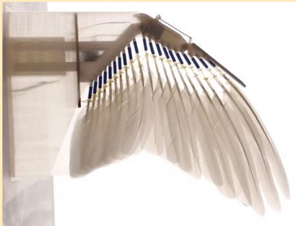
Ausschnitt aus einer Experimentdurchführung: Mit Taubenfedern bestückter künstlicher Flügel im Windkanal
